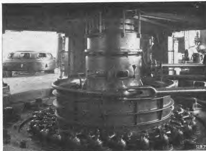
Abb. 112. Regulier-Ring der Turbinen.
