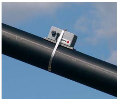
Fig. 2b Sensorknoten auf einem Seil montiert. Sensor node mounted on a stay cable.
