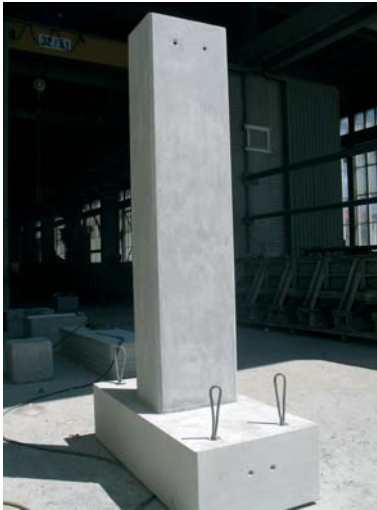
Fig. 3 Elément d'essai. Test specimen.
