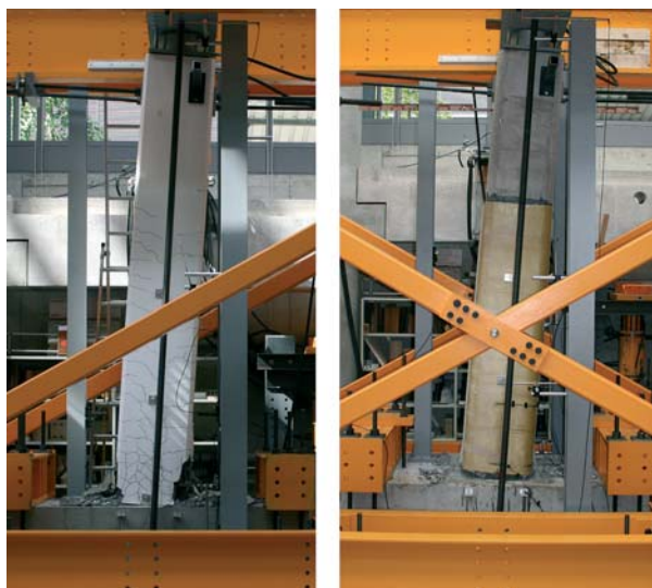
Fig. 9 Déformations des colonnes P0 et P1. Deformation at failure of columns P0 and P1.
