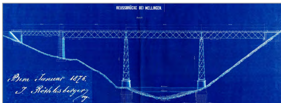
Figure 3.13 : Plan « bleu » du pont sur la Reuss de Mellingen, long de 193 m, établi à Berne en janvier 1876 par Röthlisberger. Les références du plan sont un extrait agrandi du plan (ETHZ Bibliothek).
