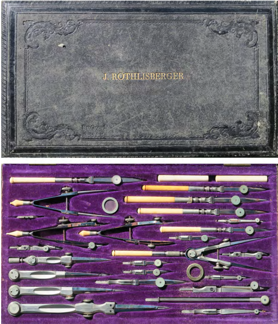
Figure 10.1 : Boîte d'instruments de dessin (tire-lignes et compas) de Jules Röthlisberger. La boîte est fabriquée par l'entreprise Fr. Gysi à Aarau. Ce nom d'entreprise est utilisé entre 1817 et 1889 (archives de famille).
