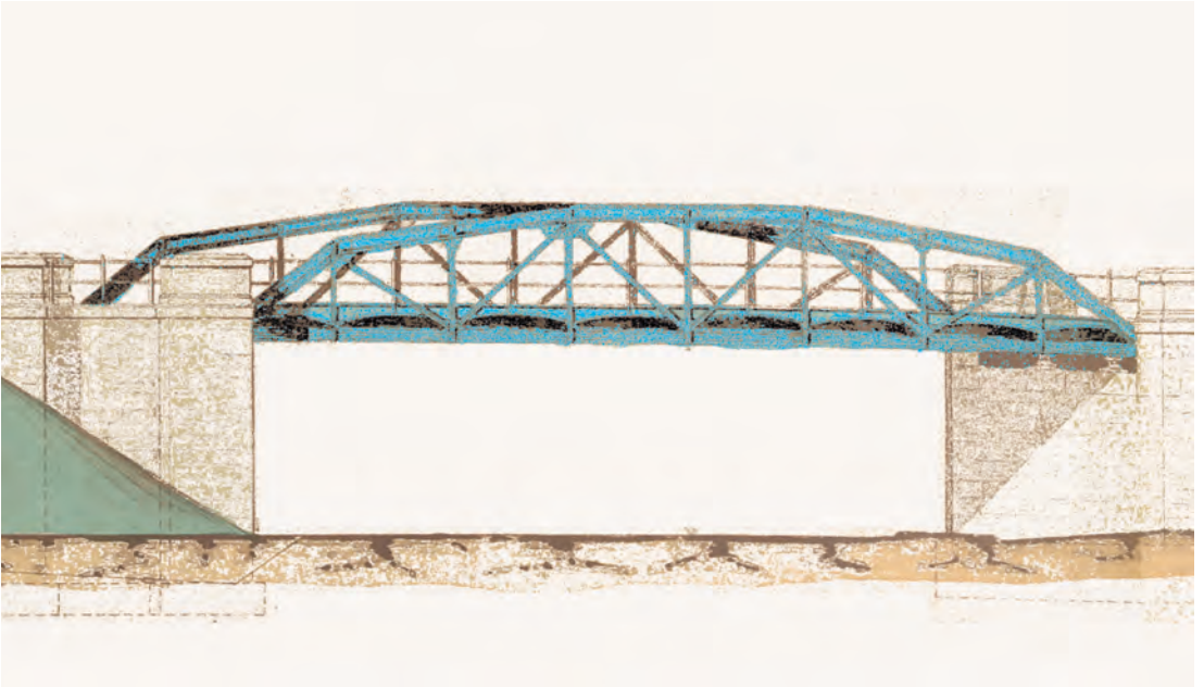
Figure 7.10 : Le projet de pont du NOB sur la route du Sihlquai approuvé le 15 mars 1892 par le Département suisse des chemins de fer (SBB Historic). La structure est renforcée à la suite de l'entrée en vigueur de l'ordonnance sur le calcul des ponts. L'administration fédérale approuve le projet d'exécution de la SNOS le 14 février 1893.
